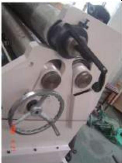
Вставьте стальную пластину между верхним и передним нижним роликами.
