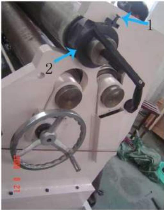
Затем откиньте верхний ролик и вытащите заготовку получившейся формы.
