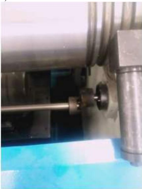
3) Затем с помощью маховика отрегулируйте расположение правой стороны верхнего и нижнего роликов так, чтобы они располагались параллельно.
