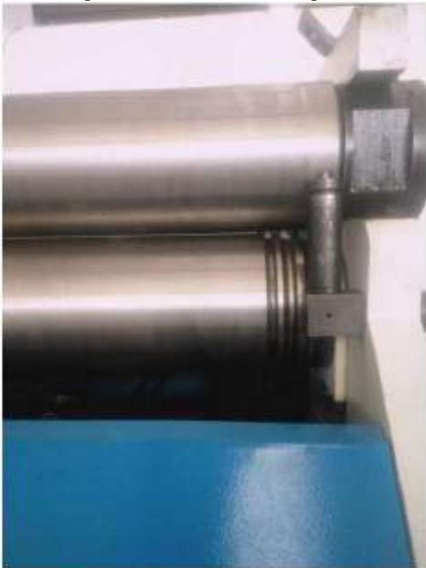
4) После этого установите **СИНХРОННЫЙ ПРИЖИМНОЙ РОЛИК**
