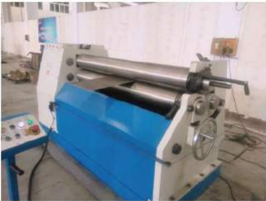
Нажмите на кнопку со стрелкой, указывающей вверх, для поднятия заднего ролика и нажмите на правую ножную педаль. Стальная пластина переместиться назад посредством привода ролика. Нажмите на левую ножную педаль. Стальная пластина переместиться вперед.
