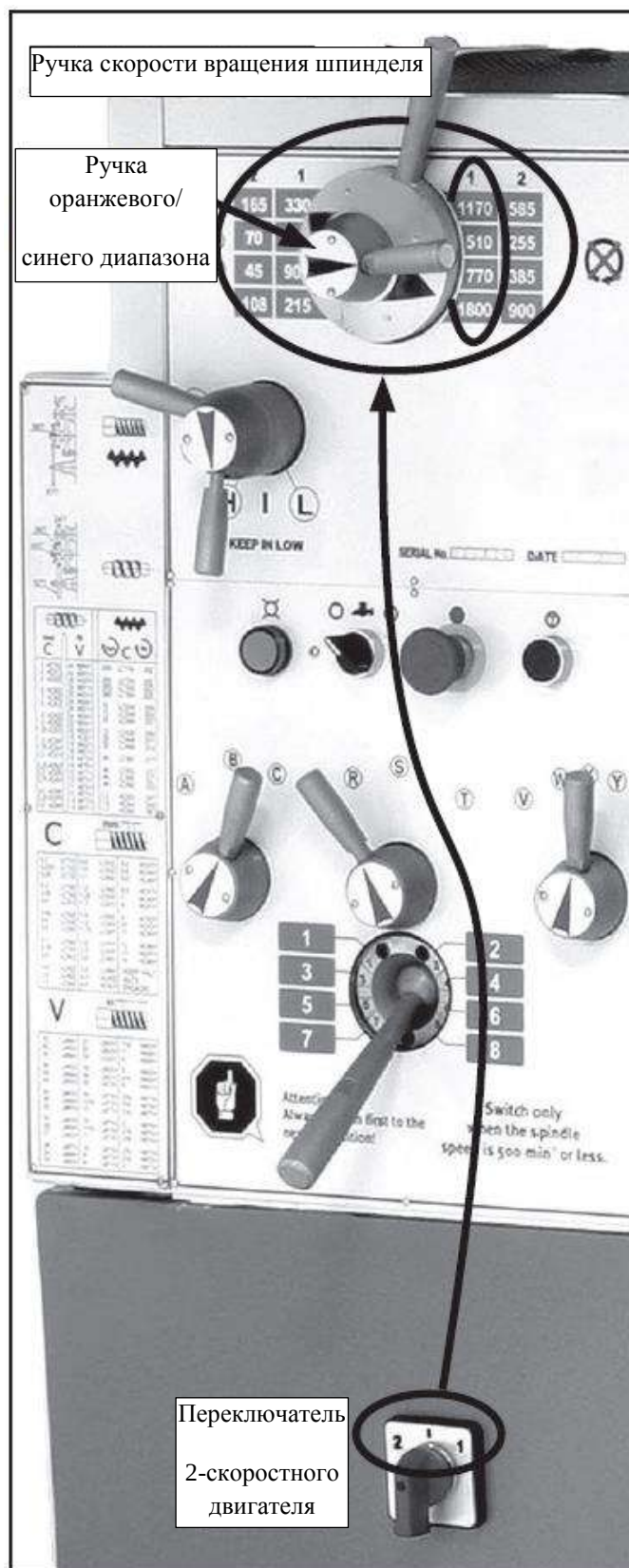
Рисунок 20. Управление скоростью вращения шпинделя
