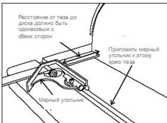
Рис. 16: Использование мерного угольника для настройки параллельности стола.
